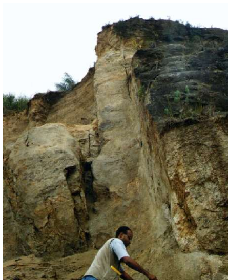
Figura 2.16 - Perfil de alteração em gnaiss com estruturas reliquias, Rio das Pedras
