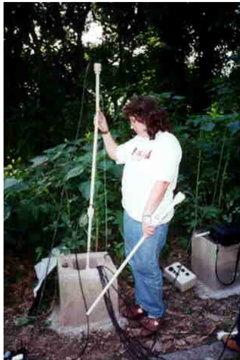
Figura 6.28 - Instalação do Cliper
