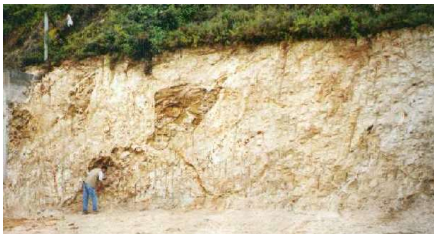
Figura 2.17 - Perfil de alteração em gnaiss Archer com estruturas reliquiare e núcleos preservados, Rua Gama Malcher
