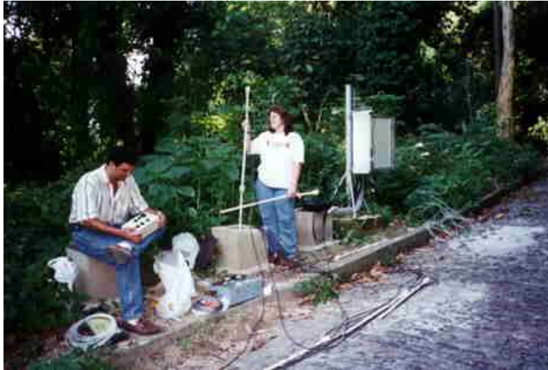
Figura 6.29 - Instalação da instrumentação, Encosta do Itanhagá
