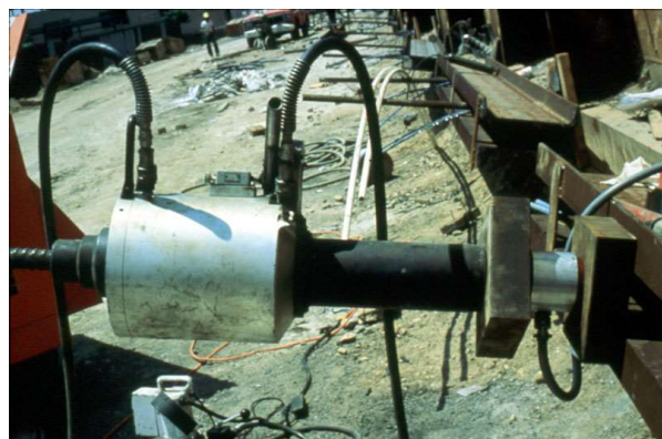
Figura 6.18 - Exemplo de emprego de célula de carga de corda vibrante em ensaio de tração
