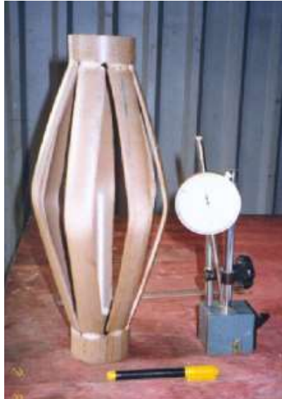
Figura 2.5 - Detalhe do centralizador (Foto Este Engenharia)
